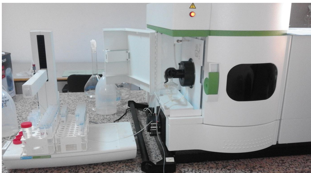
Appareil utilisé de la Spectrométrie d'Emission Atomique de Plasma d'argon à Couplage Inductif (ICP-AES)
