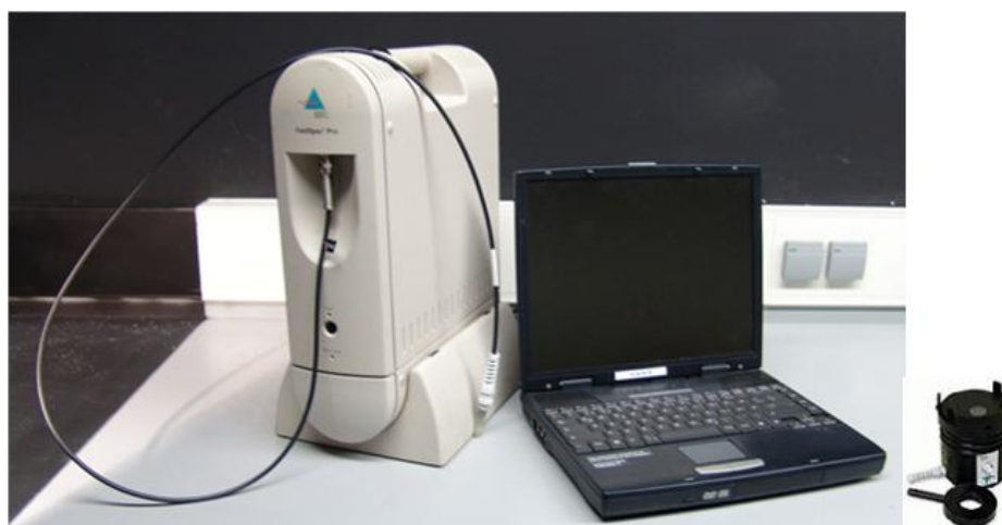
Figure 17. Exemple du spéctroradiomètre ASD utilisé.
