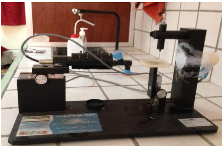
Figure II.11: Dispositif expérimental de caractérisation des angles de mouillage (GBX France).
