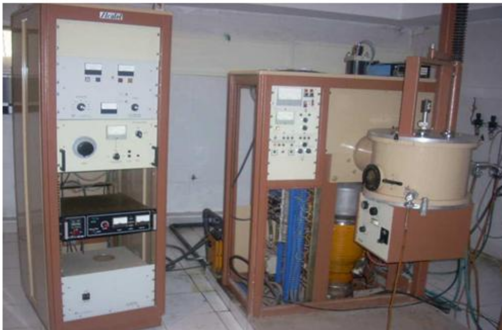
Figure II. 6 : Photo du dispositif expérimental de la pulvérisation.
