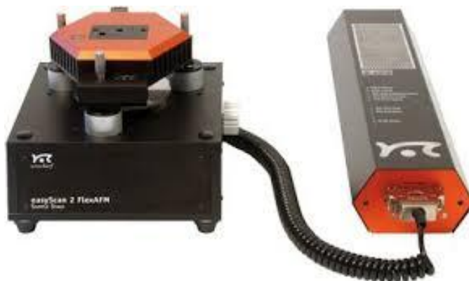
Figure II. 21 : Image du microscope à force atomique Nanosurf Easyscan 2 AFM.
