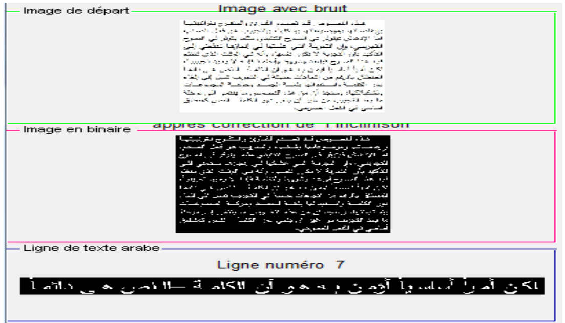
Figure 2-15 Résultat de suppression de la ligne de base d'une ligne du texte arabe avec la méthode de calcul d'épaisseur d'écriture.
