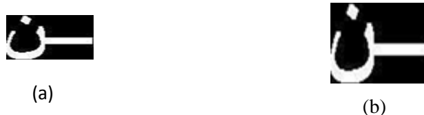
Figure 2-22 (a) Image avant la normalisation, (b) Image après la normalisation de taille.
