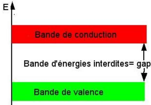
Figure 3. Diagramme énergétique montrant le gap d'un matériau semi-conducteur.
