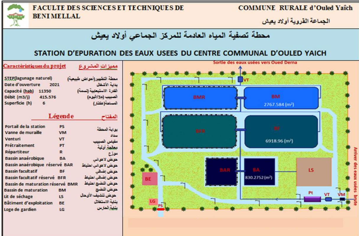
Figure 86 : schéma conceptuel de la STEP proposée pour la commune d'Oulad Yaich
