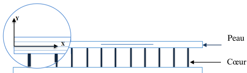
FIGURE 5.1 – Structure de matériau Sandwich avec une peau endommagée.
