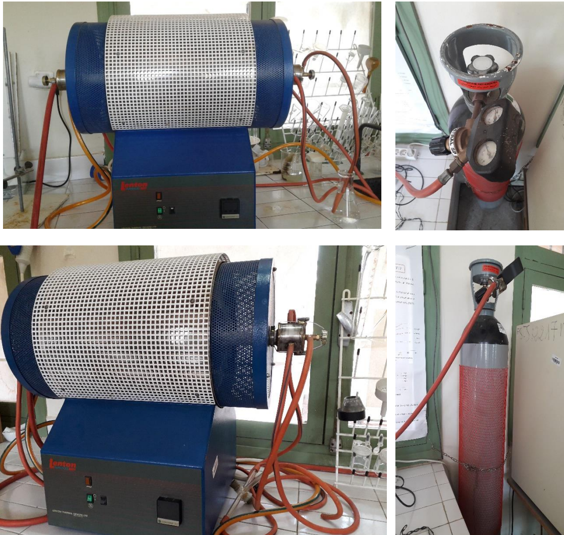
Figure 52: Four et éléments employés pour le fonctionnement sous N_2
