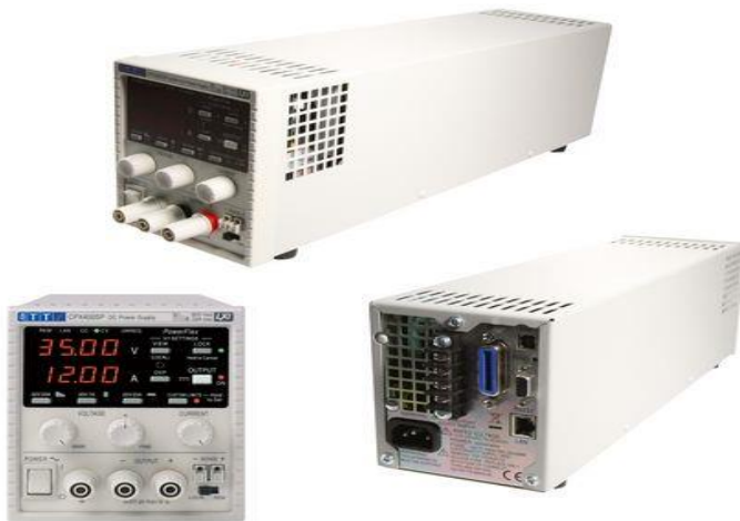
Figure 20: Générateur électrique utilisé dans le montage d'électrolyse d'eau
