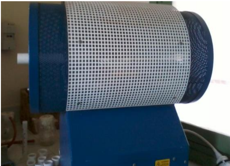
Figure 30: Four utilisé pour le traitement thermique des électrodes
