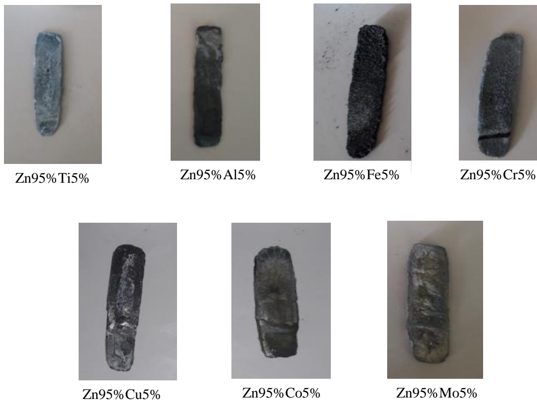
Figure 37: Photos des cathodes préparées à base des métaux de transition
