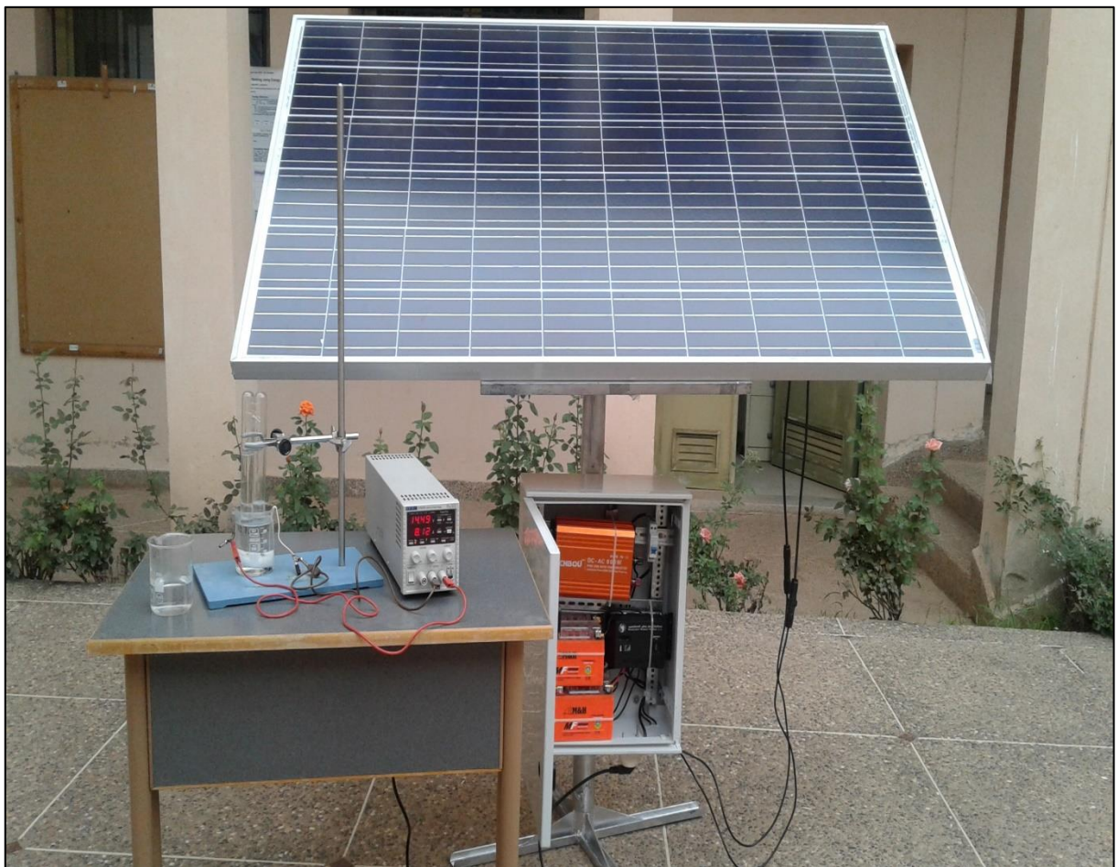
Figure 16: Montage expérimental de la production d'H 2 par électrolyse d'eau à partir l'énergie solaire
