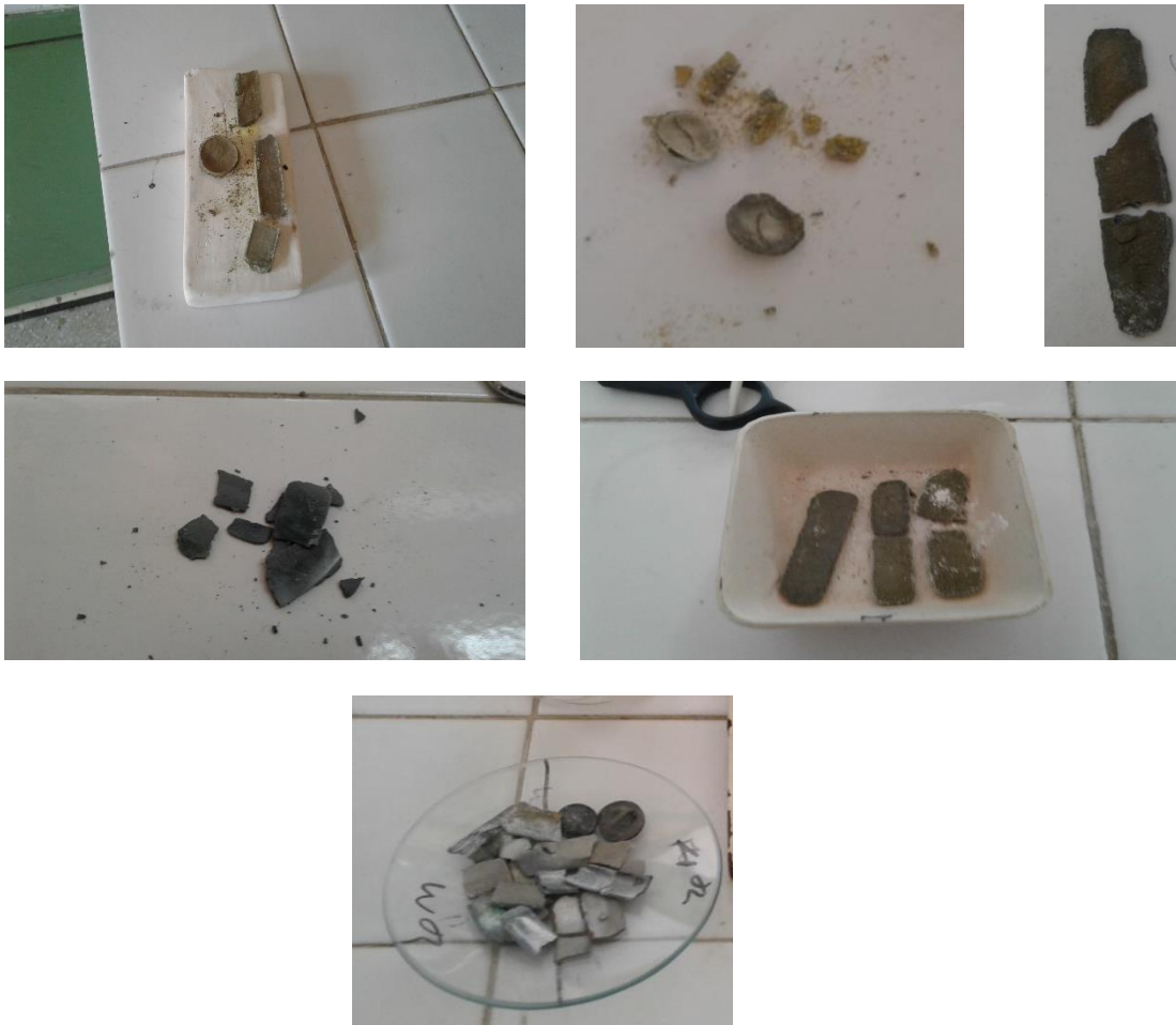
Figure 31: Photos des premières électrodes préparées (cassées)
