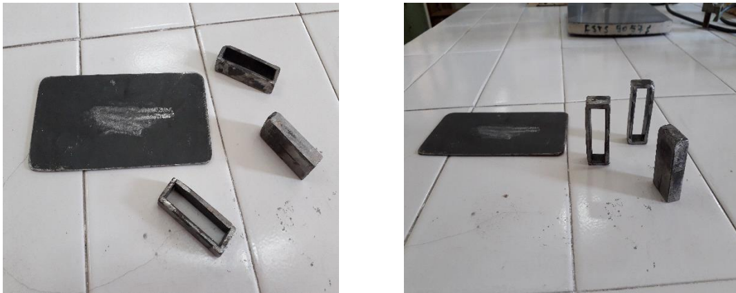
Figure 26: Outillage utilisé pour le pressage de poudre
