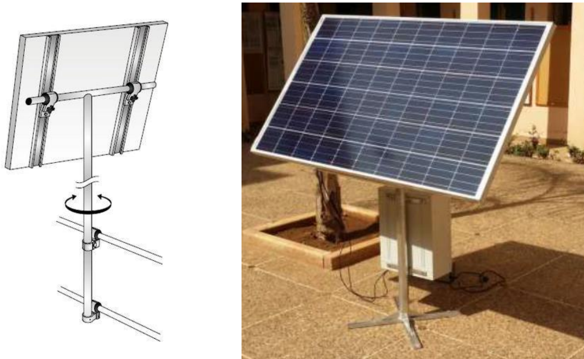
Figure 18: Module photovoltaïque utilisé pour alimenter la cellule d'électrolyse d'eau
