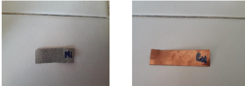
Figure 33: Plaque à base de Nickel et plaque à base de Cuivre utilisées comme anodes
