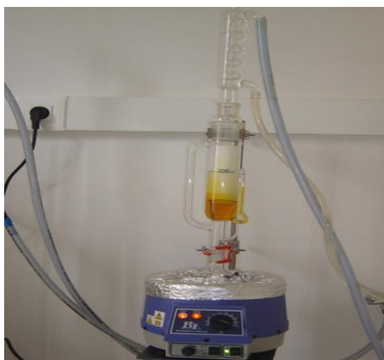
Figure 17. Montage d'extraction par soxhlet
