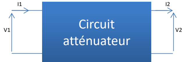
Figure A- 1: Schéma d'un circuit à deux ports
