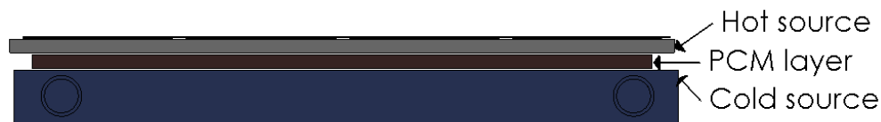
Figure 5. 16 : Présentation du système PV / MCP, conditions aux limites et géométrie
