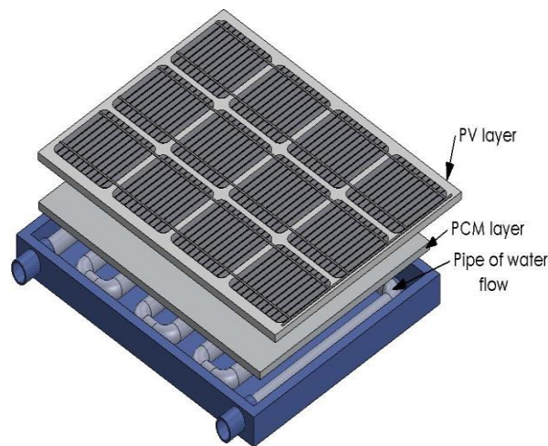
Figure 5. 15 : le système hybride thermo-photovoltaïque
