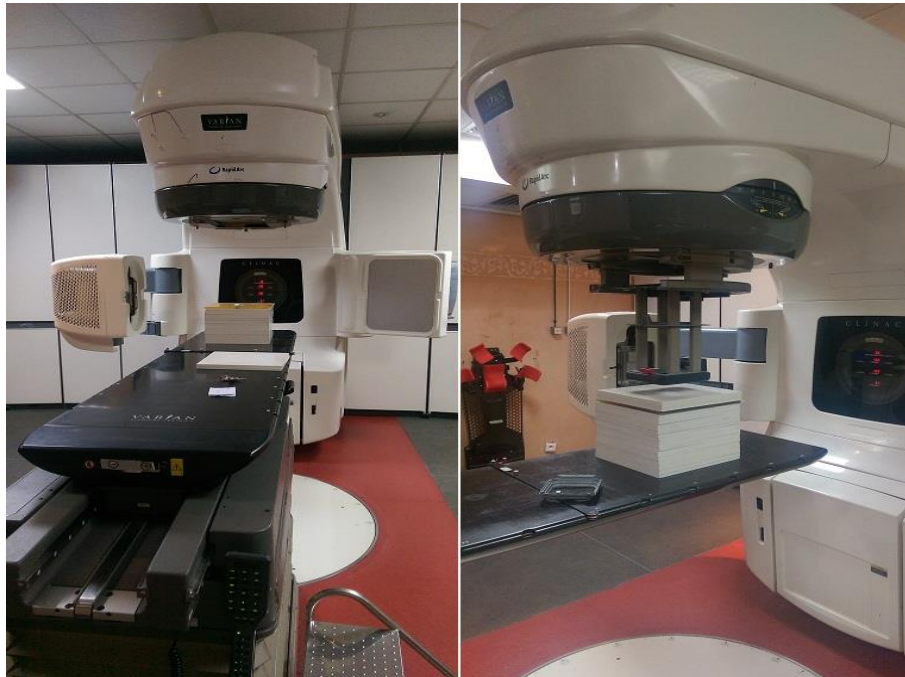
Figure IV.2. Accélérateur linéaire du centre d'oncologie Al Kindy à Casablanca : Irradiation aux photons (à gauche), Irradiation aux électrons (à droite).
