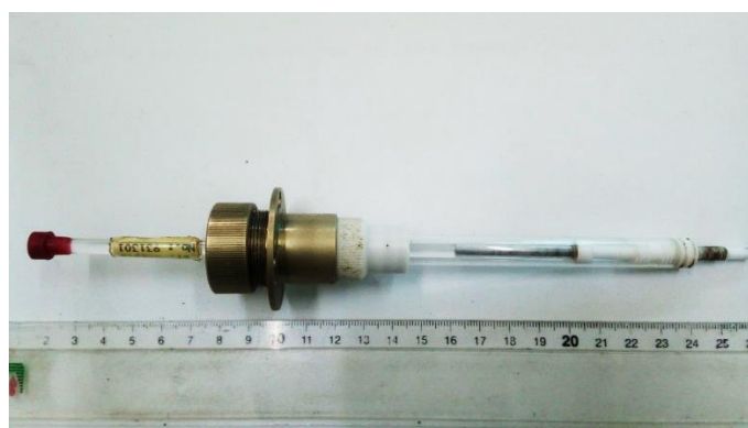
Figure IV.8. Support des tubes utilisé pour fixer les tubes à l'intérieur de la cavité.
