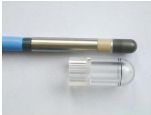
Figure III.6. Exemple de chambre d'ionisation type PTW-Freiburg 31010
