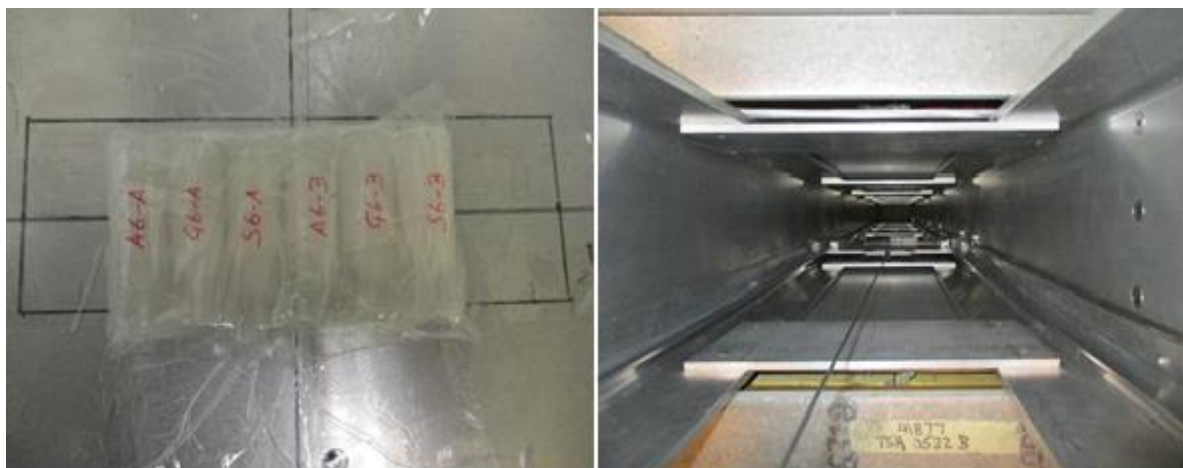
Figure IV.6. Disposition des tubes d'échantillons pour l'irradiation aux neutrons.
