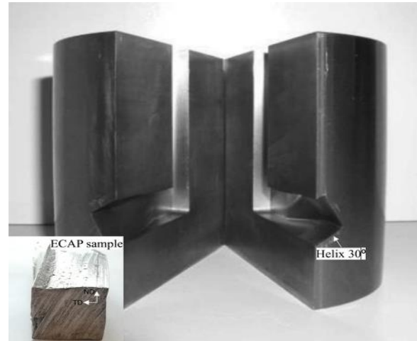
Figure 47 : Schéma de principe de l'ECAP. L'échantillon (test material) passe au travers d'une filière (die) coudée avec un angle \phi par l'application d'une pression via un piston (plunger).
