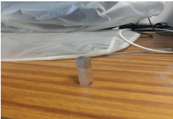
Figure 50: Alliage Al-Sn après 3 passes de l'ECAP
