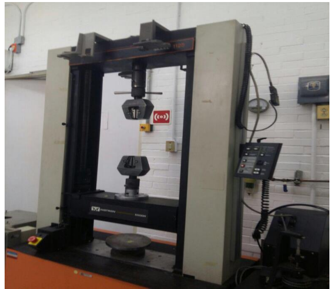
Figure 49: Appareillage de déformation plastique sévère sur les alliages AlSn
