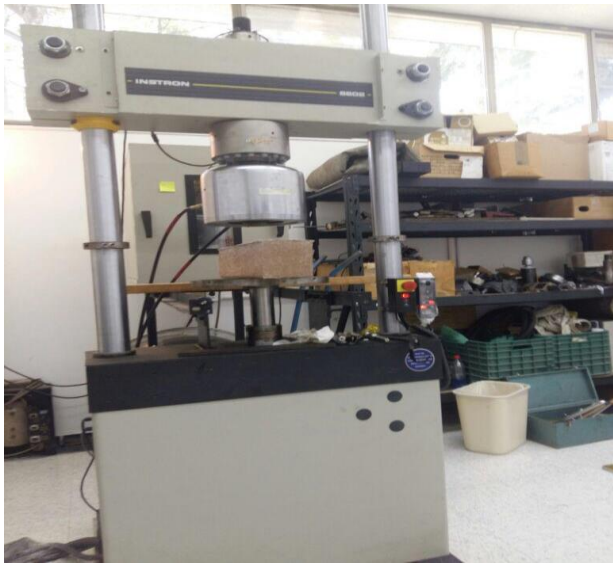
Figure 49: Appareillage de déformation plastique sévère sur les alliages AlSn
