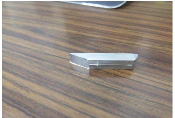
Figure 50: Alliage Al-Sn après 3 passes de l'ECAP
