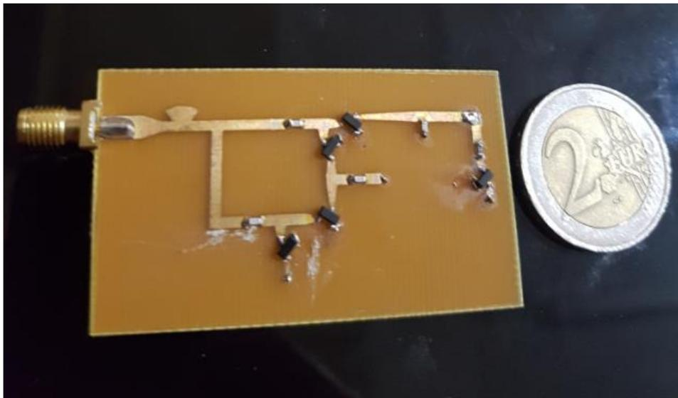
Figure 112. Redresseur multiplicateur de tension à 5.8 GHz fabriqué.
