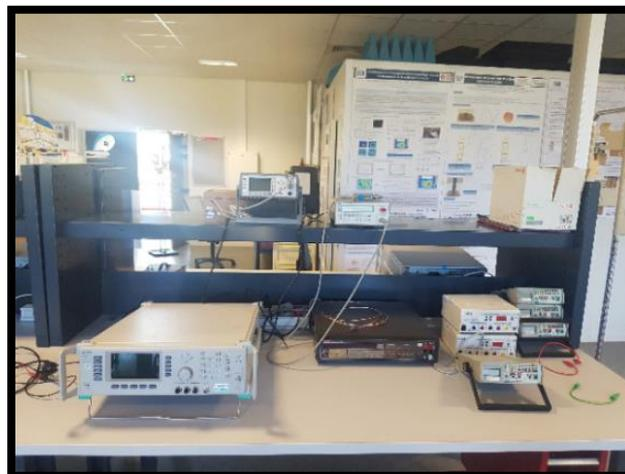
Figure 118. Banc de mesure de test du redresseur série avec filtre passe-bas à 2.45 GHz
