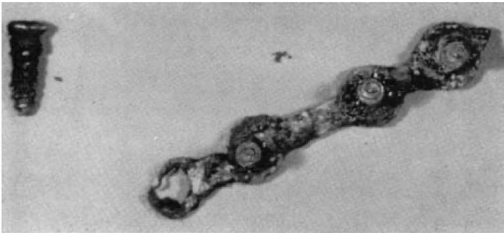
Figure 6. La plaque de Lane a été abandonnée à cause de la corrosion (1895). (D'après BECHTOL CO, Fergusson AB, Laing PE. Metals and Engineering in Bone and Joint Surgery. Williams & Wilkins ; Baltimore : 1959. p. 20
