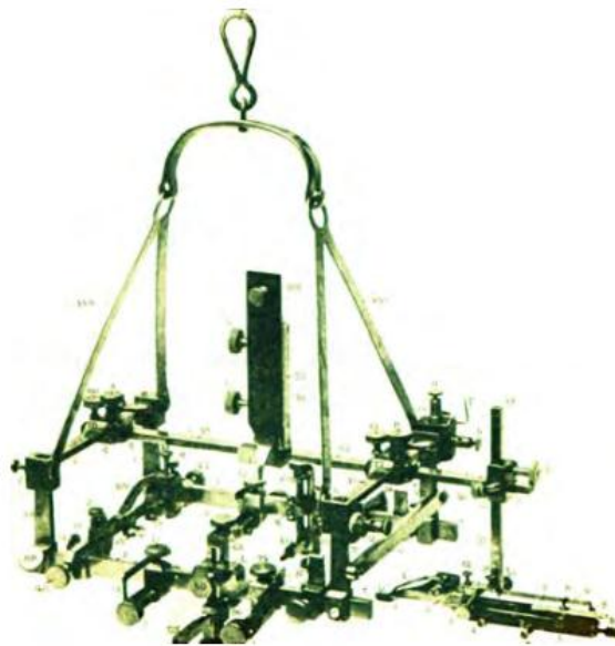
Figure 7. Le cadre de Horsley et Clarke utilisant des calculs stéréotaxiques basés sur les coordonnées cartésiennes pour localiser les cibles intracrâniennes dans les expérimentations animales. [6]
