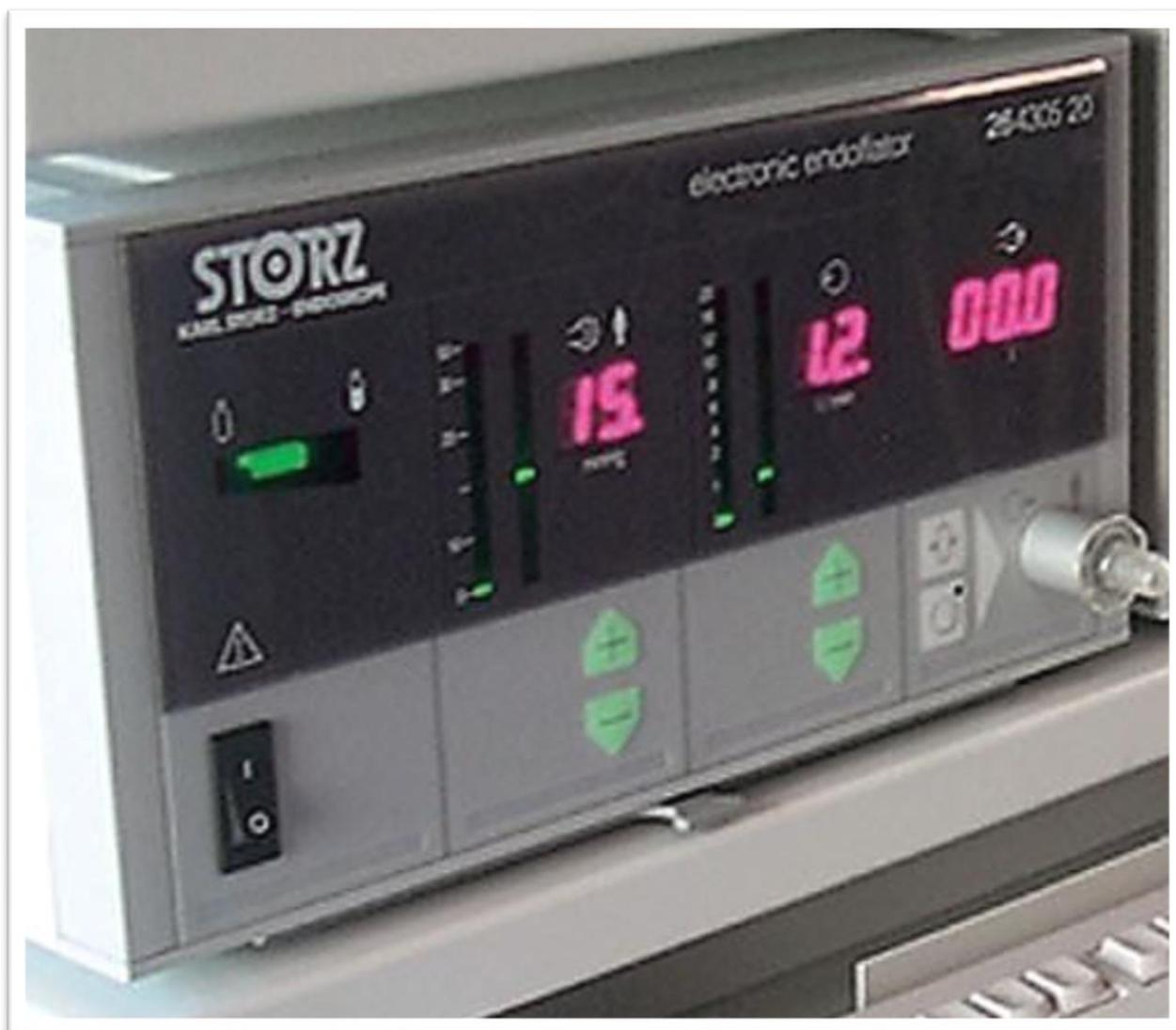
**Figure 15 :** Insufflateur électronique
