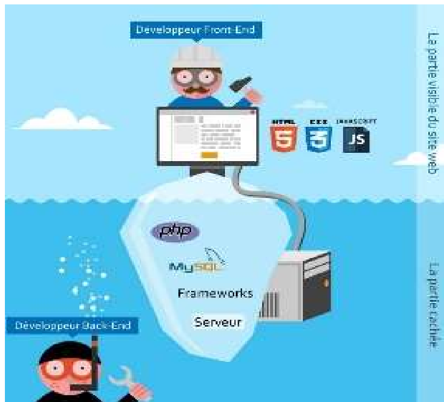
Figure 11: Illustration démonstrative de la différence entre le Back-End et le Front-End
