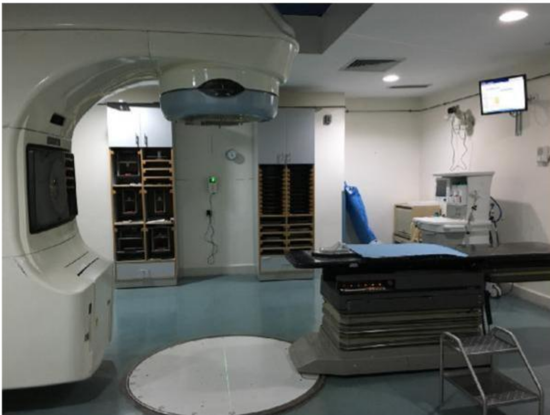
Figure 17 : Accélérateur linéaire au service de radiothérapie (CHU HASSAN II de FES)
