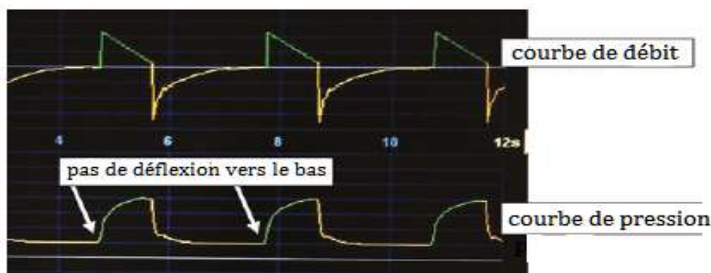
Figure 24 : Dans cette figure, la courbe de débit se trouve sur la ligne supérieure, et la courbe de pression sur la ligne inférieure. Notez que chaque forme d'onde est identique. Notez également qu'il n'y a pas de déviation vers le bas au début de chaque respiration, ce qui indique qu'il s'agit de respirations déclenchées par une machine 3 .
