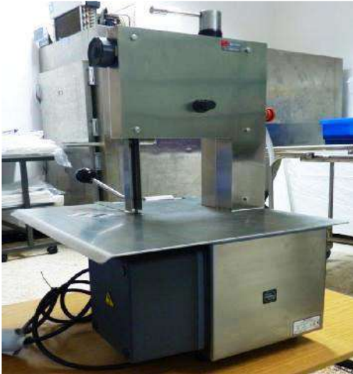
Scie électrique permettant de réaliser les coupes transversales
