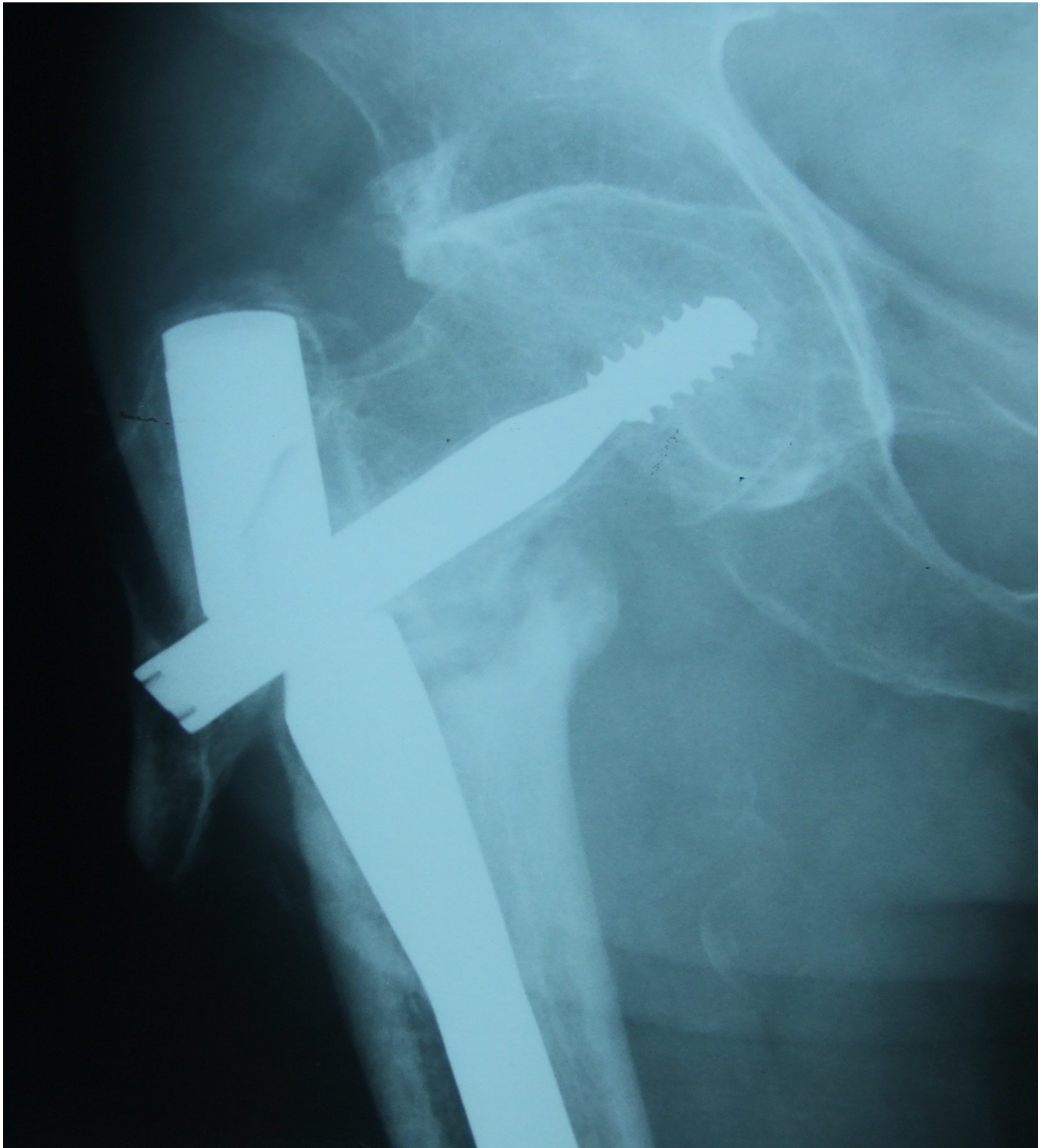
Figure 15: Radiographie de face montrant une fracture de matériel (Clou gamma)
