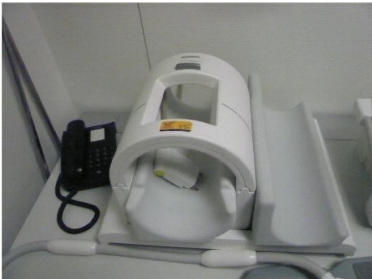
Figure 11 : Antenne de réception du genou
