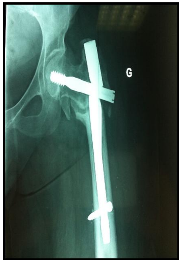
Figure 74 : Aspect radiologique et macroscopique peropératoire d'une rupture de clou gamma
