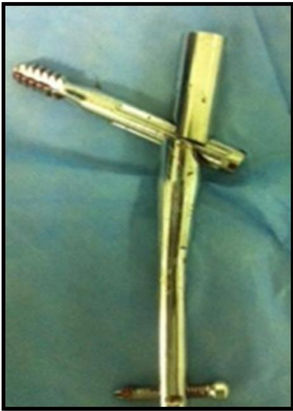
Figure 74 : Aspect radiologique et macroscopique peropératoire d'une rupture de clou gamma
