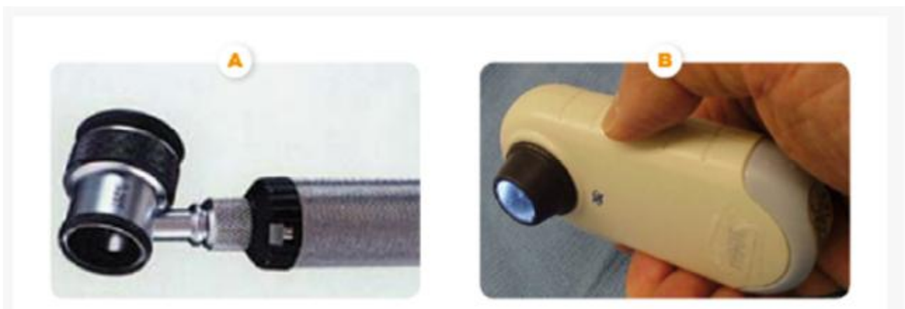
Figure 13 : Deux types distincts de dermatoscopes. A: dermatoscope à immersion dans l'huile. B: dermatoscope sec à lumière polarisée croisée alimenté par piles.
