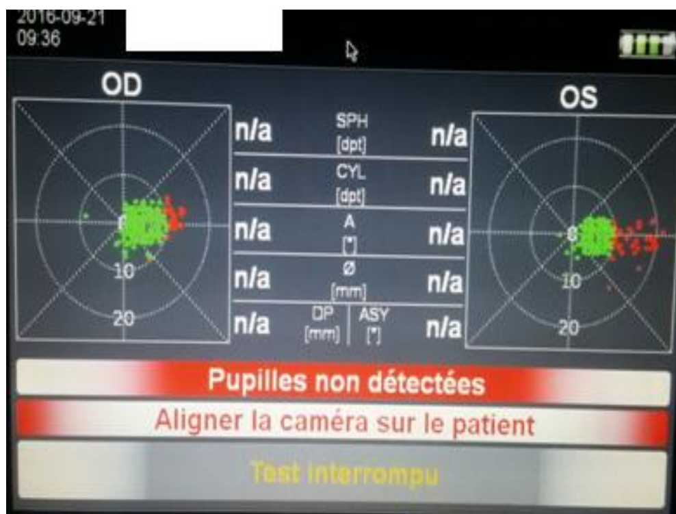
Figure 55 : Image de l'écran du Plusoptix affichant le message d'erreur « pupilles non détectées »
