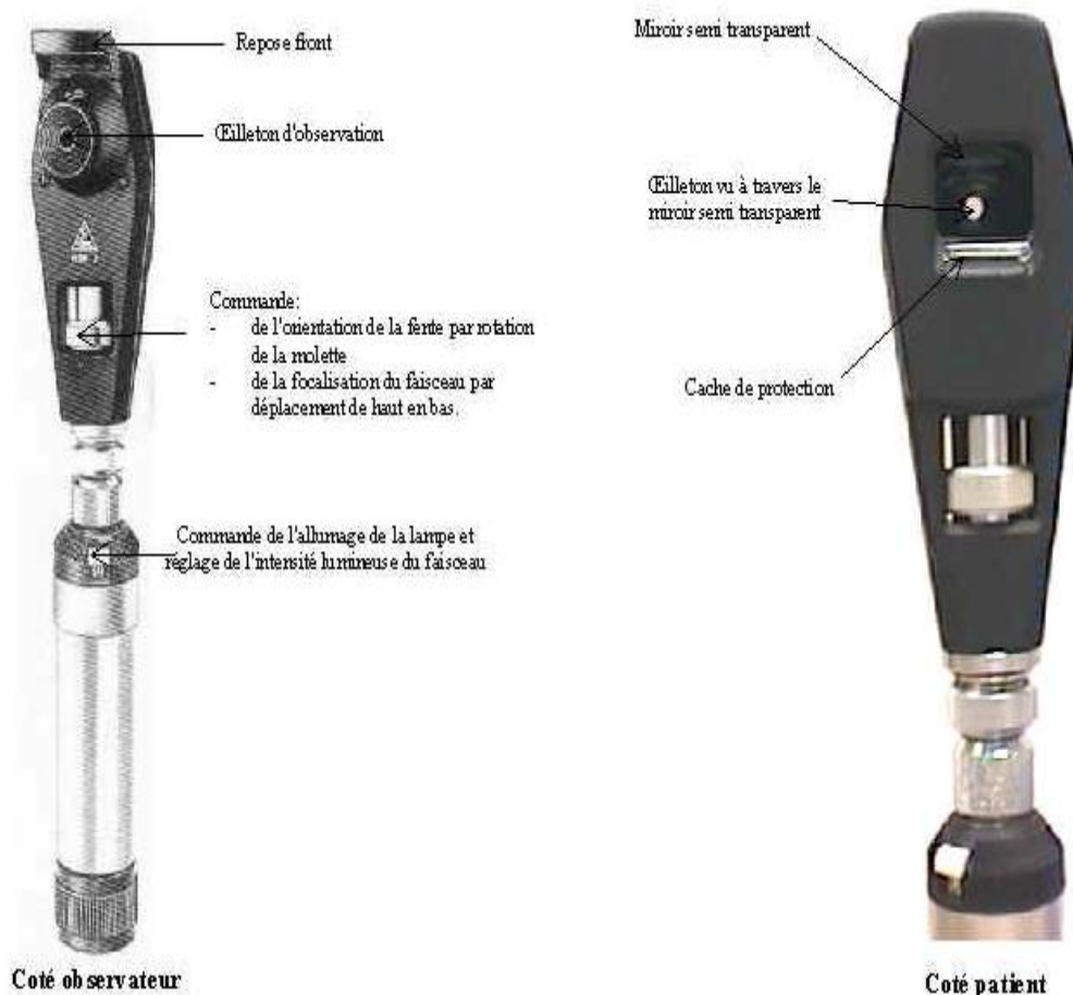
Figure 19 : Constitution d'un skiascope
