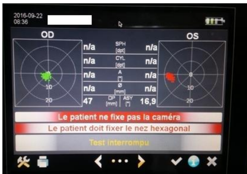
Figure 51 : Image d'un message d'erreur sur l'écran du Plusoptix A 12 « le patient ne fixe pas la caméra », chez un patient présentant un strabisme à grand angle.
