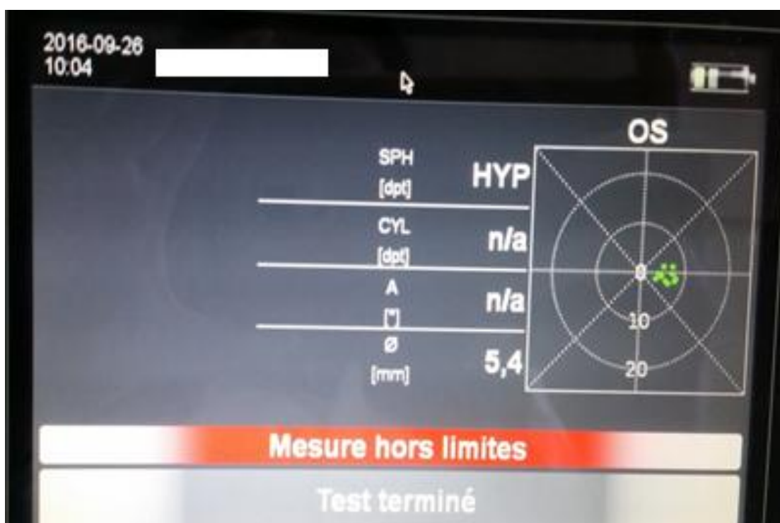
Figure 59 : Image de l'écran du Plusoptix affichant le message « HYP »
