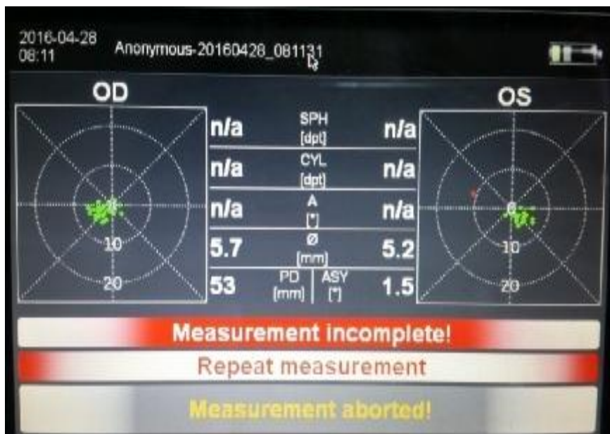
Figure 53 : Image de l'écran du Plusoptix affichant le message d'erreur « mesure incomplète »
