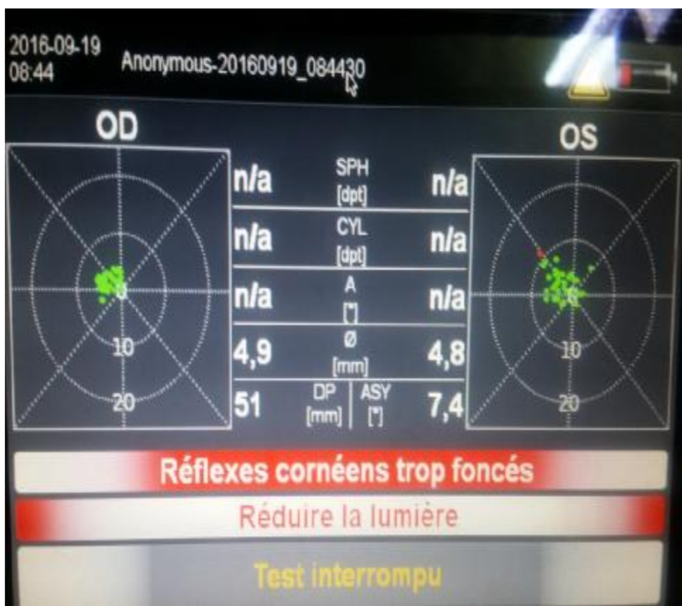
Figure 56 : Message d'erreur « Réflexes cornéens trop foncés »
