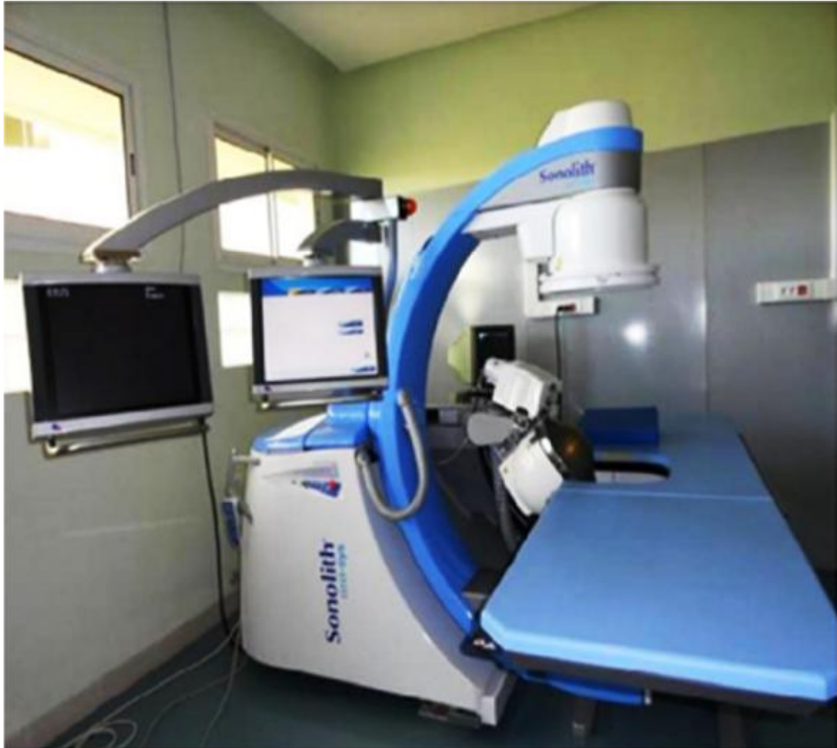
Figure38 : Lithotriteur à source électroconductive Sonolith i-sys du service d'urologie CHU HASSANII Fès.
