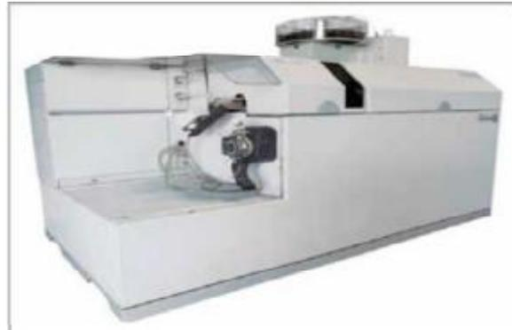
**Figure n°1** : Appareil de spectrométrie d'émission atomique couplée à spectrométrie de masse (ICP-MS).
