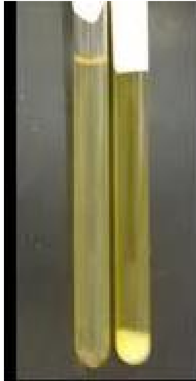
figure17 : Image montrant une cryoprécipitation (tube droit), tube gauche témoin
