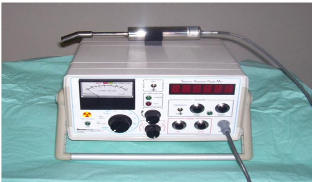
Figure 11 : Sonde de détection isotopique. Gamma probe counter (11)
