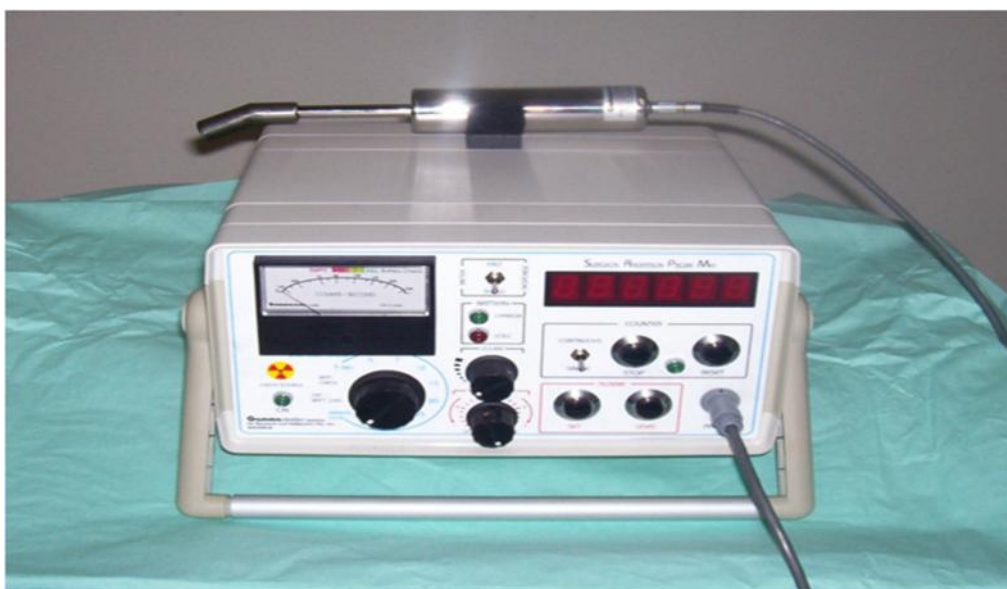
Figure 22 : sonde de détection isotopique (11)
