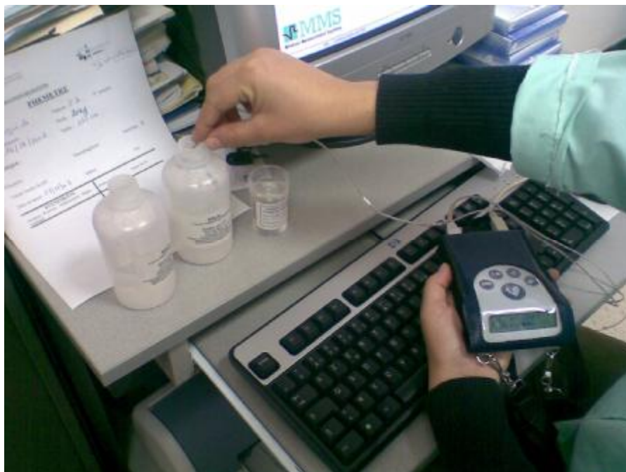
Photo 2 : Etalonnage du système. Solution de PH 4 et 7. (Service de pédiatrie du CHU Hassan II de Fès)
