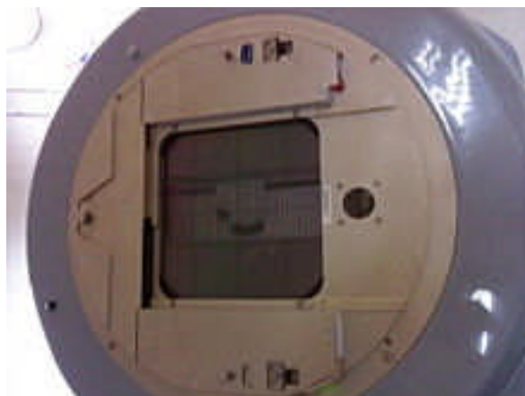
Fig. 18 : Collimateur multilames dans la tête d'un accélérateur linéaire.
