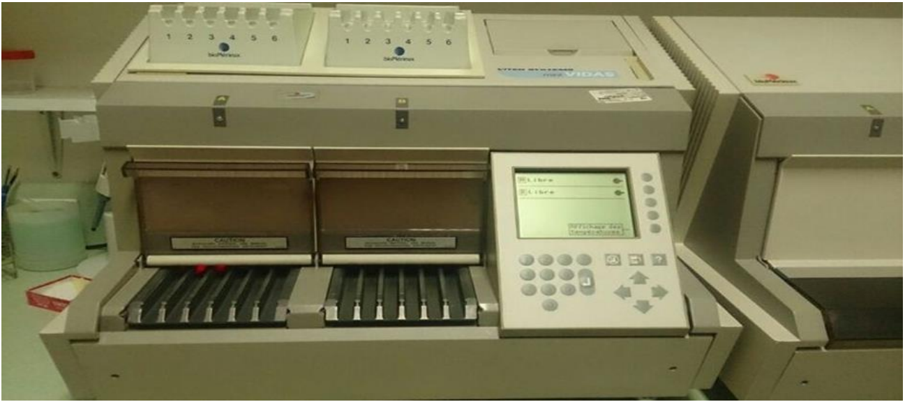
Figure 23: Automate Mini vidas® Bio Mérieux/IM Alliance (Photo personnelle)
