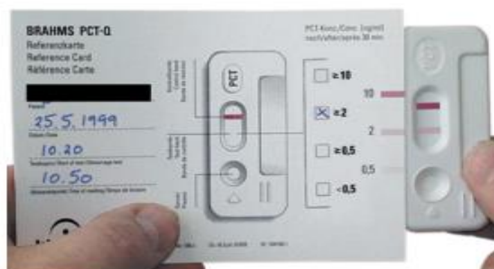
Figure 12: kit de PCT-Q comprenant la savonnette et l'abaque de lecture (29)
