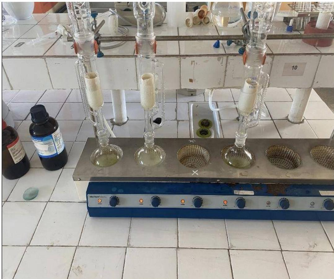
Figure 20 : Extraction de l'huile fixe par Soxhlet
