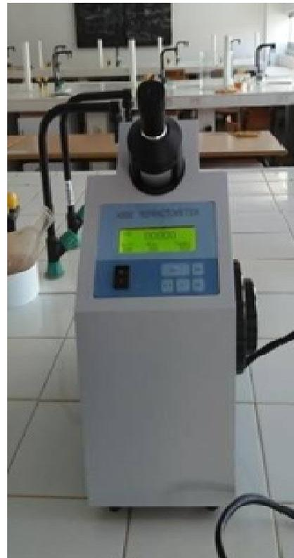
**Figure 22 : Réfractomètre électronique ABBE REFRACTOMETER
