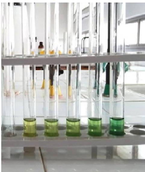
**Figure 31 : Virage de la coloration jaune du ferrocyanure de potassium au bleu-vert du bleu de Prusse après l'ajout de  $\text{FeCl}_3$**
