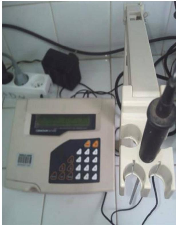
Figure 23 : pH – mètre (Laboratoire de Chimie analytique FMPR)
