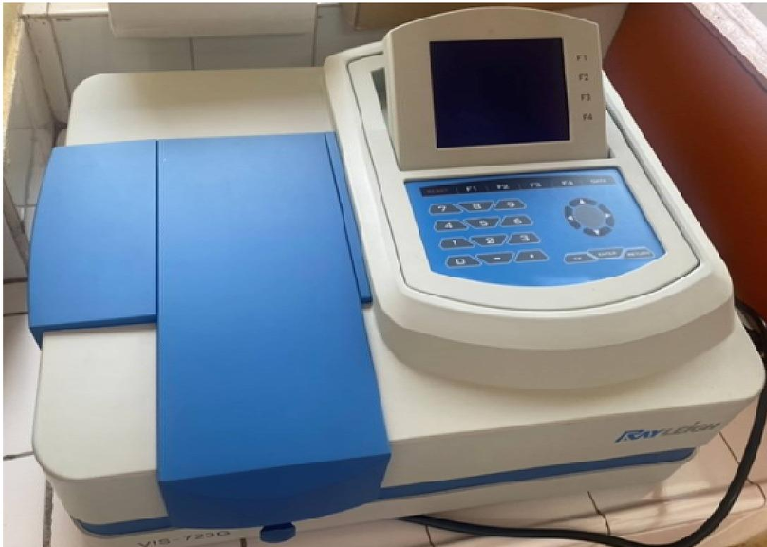
**Figure 26 : Spectrophotomètre UV-Visible RAYLEIGH Modèle : VIS 723G**
