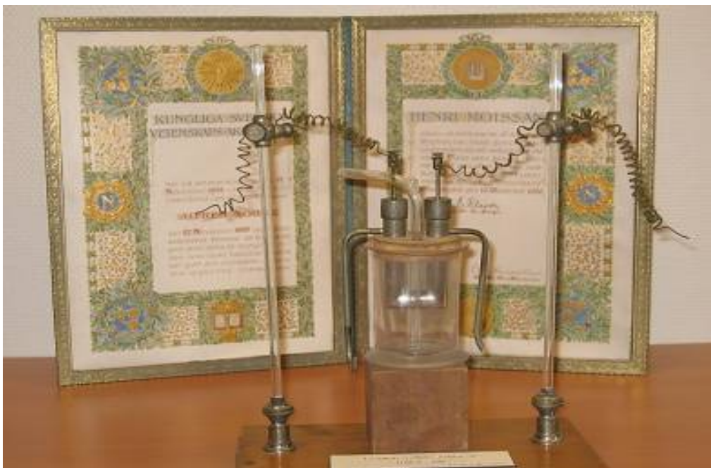
Figure 9 : Le prix Nobel d'Henri Moissan et la cellule électrolytique de production de fluor (61)
