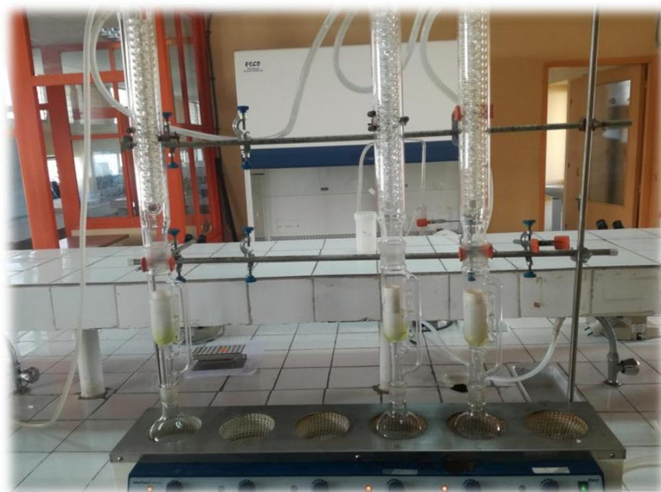
Figure 28. Extraction de l'huile fixe par Soxhlet
