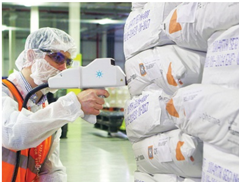
Figure 63: Utilisation de spectroscopie RAMAN pour l'identification en temps réel des matières premières.
