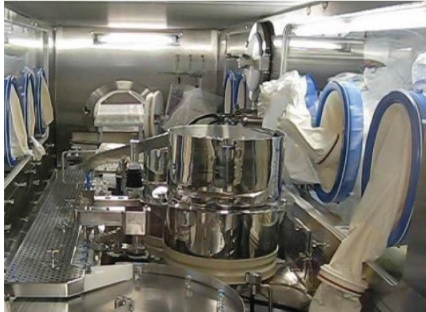
Figure 35: Un opérateur en train d'introduire des bouchons stériles dans une trémie grâce aux manchettes-gants.
