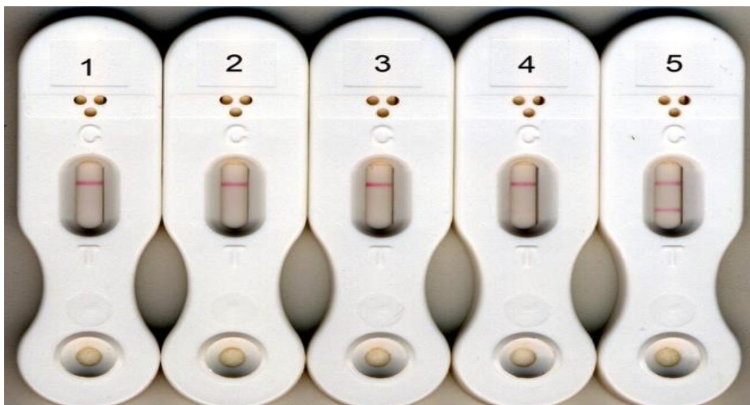
Figure 15 : Test LFD sur sérum humain normal après inoculation avec des champignons et incubation pendant 48 h à 37°C [213] .
