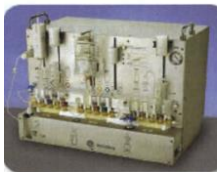
Photo 2 : un automate de synthèse du [^{18}\text{F}] FDG. [23]
