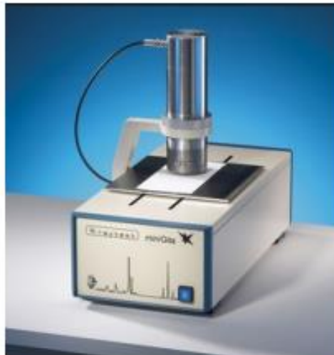
Photo 3 : Exemple d'appareil qui permet la mesure des rayonnements gamma.[22]
