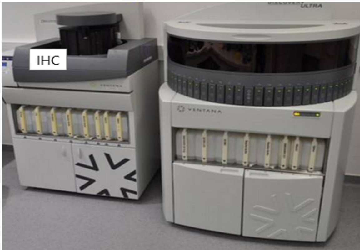
Figure 17 : Automates de marquage immunohistochimique respectivement de gauche à droite, le Discovery XT et le Discovery Ultra
