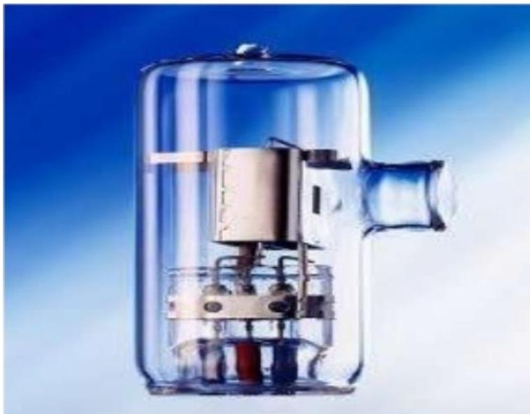
*Figure 33 : photo d'une lampe à deutérium*
