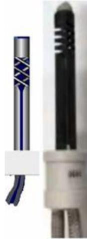
*Figure 36 : Filament de Globar [83].*
