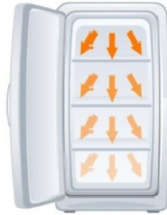
Figure 19 : Représentation de la circulation de l'air dans une enceinte à froid brassé (90)
