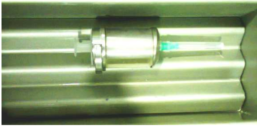
Figure 42: protège seringue hautes énergies en tungstène.
