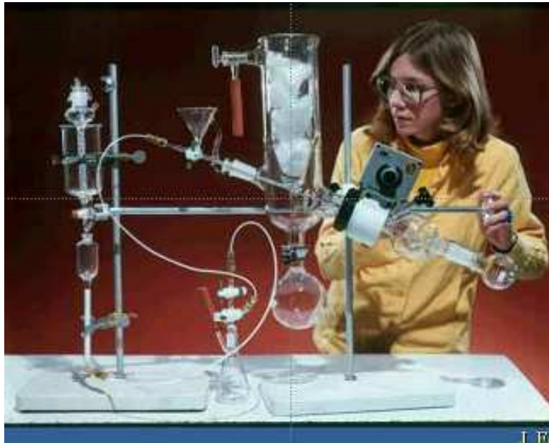
Figure 3: Premier synthétiseur de ^{18}\text{F} -FDG en 1978. (Photo tirée de la collection du professeur J. Brookhaven, laboratoire national, new York, USA) [8].
