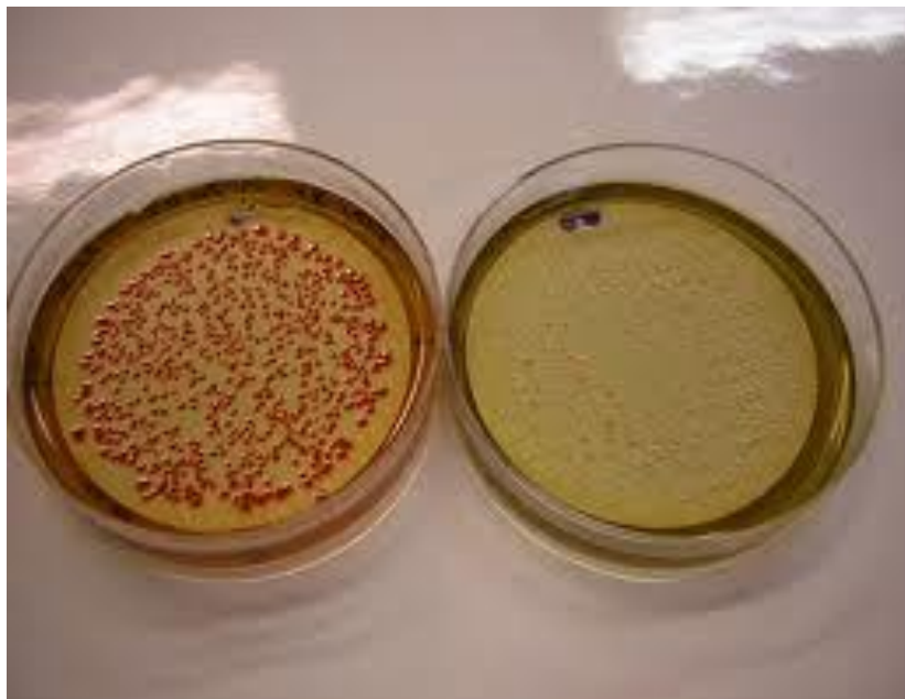
Figure 5 : Membrane filtrante contenant des colonies des Coliformes Totaux après 24 h d'incubation à 37 0 C [83].
