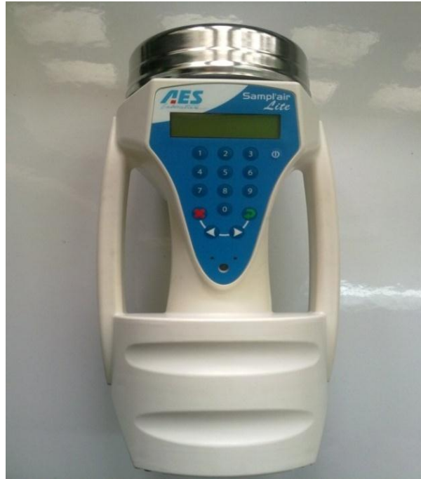
Figure 1 : Biocollecteur d'air de type (SAMPL'AIR AES) (Photo du Laboratoire de Parasitologie Mycologie, HMIMV)
