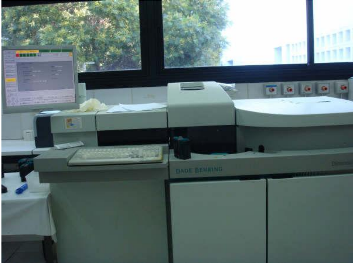
Figure 4. Auto-analyseur RXL Dimension® de la société Dade-Behring (laboratoire de biochimie et de toxicologie, HMIMV)
