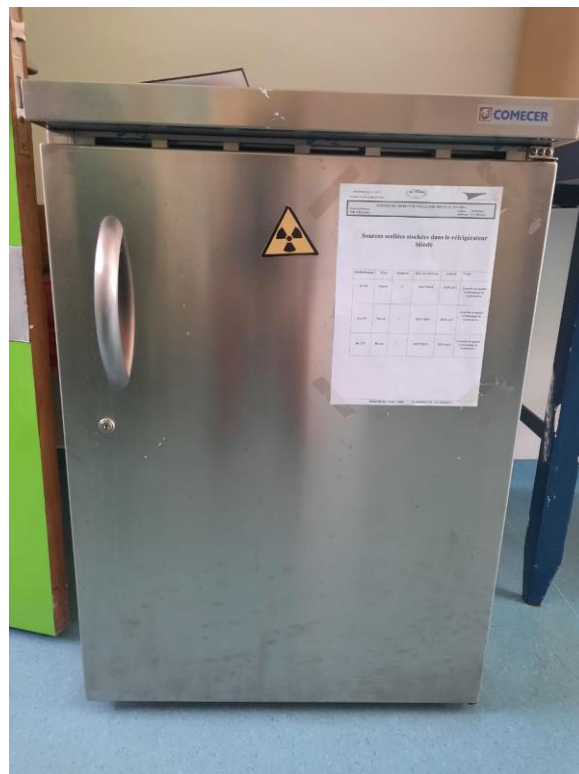
Figure 5 : Enceinte de stockage réfrigérée et protégée (Service de Médecine Nucléaire HIS).
