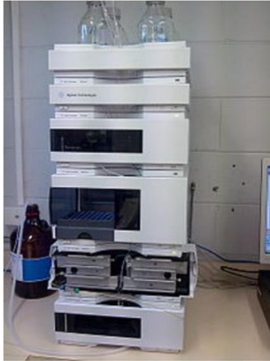
Figure 13 : Dispositif de chromatographie en phase liquide à haute performance (46).
