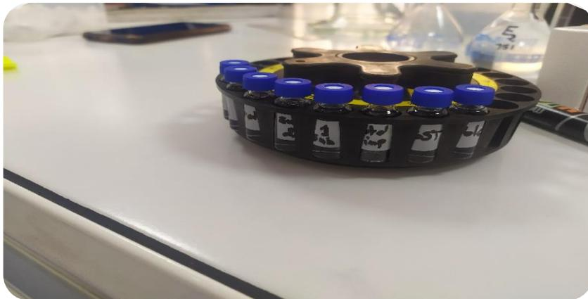
**Figure 9** :Les vials utilisées pour l'HPLC
