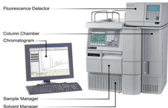
**Figure 5** : chromatographie liquide à haute performance.
