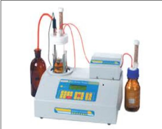
✚ Le titrage par la méthode Karl Fischer consiste en l'indication du point final qui est donnée par la mesure de la tension sur une électrode polarisée, la dérive correspond à la quantité d'eau pénétrant en un temps donné dans la tête de titrage , elle est indiquée en  **$\mu\text{g H}_2\text{O}/\text{min}$** .
