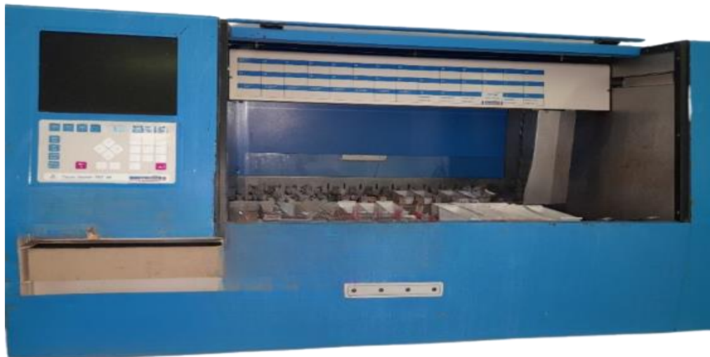
Figure 34: appareil contenant les bains de coloration HE (prise dans LACP, Ibn Sina, Rabat)
