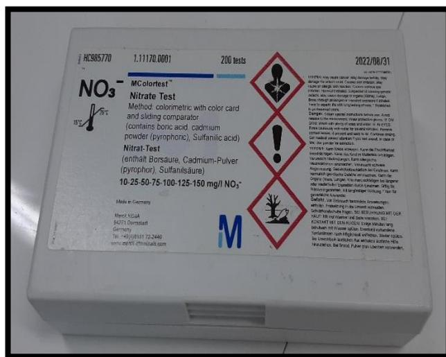
Figure 31 : Kit de dosage des nitrates dans l'eau potable.
