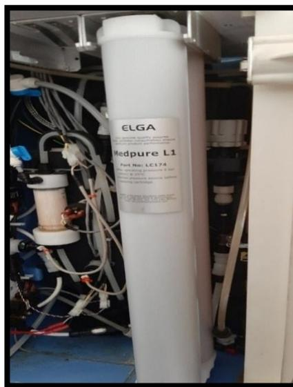
**Figure 20 : Représentation de la résine purificatrice Medpure du système de purification MEDICA**
