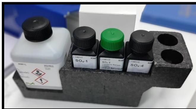
**Figure 33: Kit de dosage des sulfates dans l'eau potable.**
