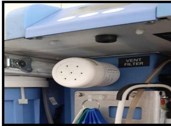
**Figure 21 : Représentation filtre évent piège à CO<sub>2</sub> du système de purification MEDICA**
