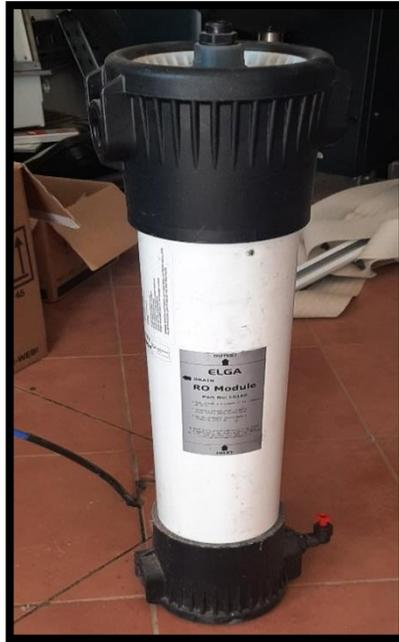
**Figure 18 : Représentation des modules d'osmose inverse du système de purification MEDICA**
