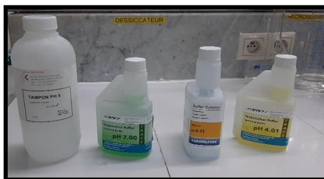
**Figure 30 : Solutions d'étalonnage du pH mètre.**
