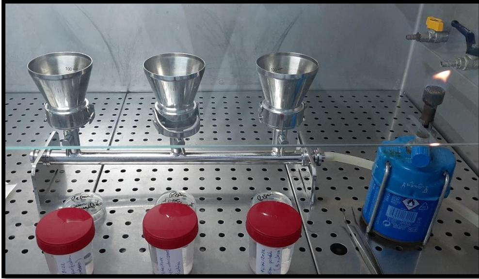
**Figure 27 : Technique de filtration sur membrane.**
