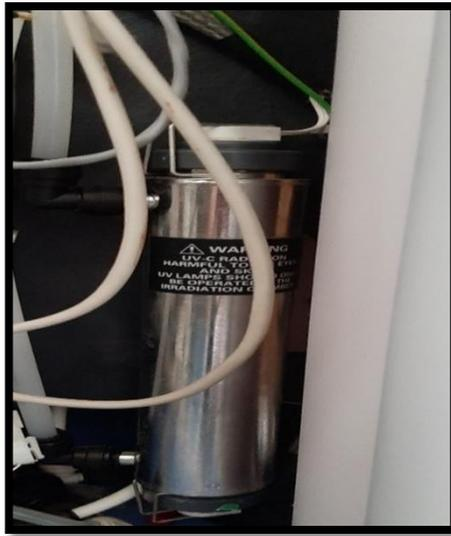
**Figure 19 : Représentation de la lampe UV du système de purification MEDICA**
